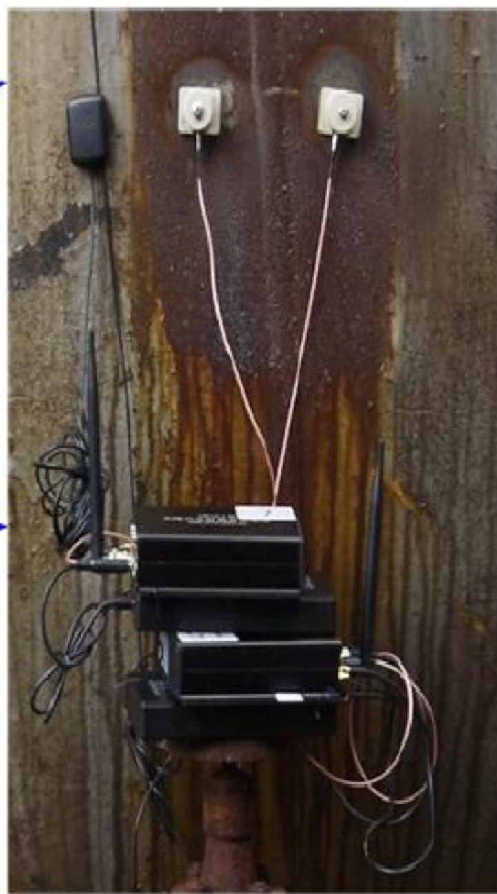
无线采集模块 (传感器+采集卡+GPS)
